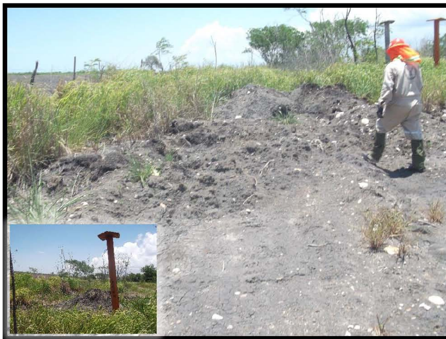
Fotografía 8.- Montículo de material con hidrocarburo intemperizado sobre Derecho de Vía del Pozo Barcodón 160, en las coordenadas UTM WGS84 X: 606644 Y: 2498137.
