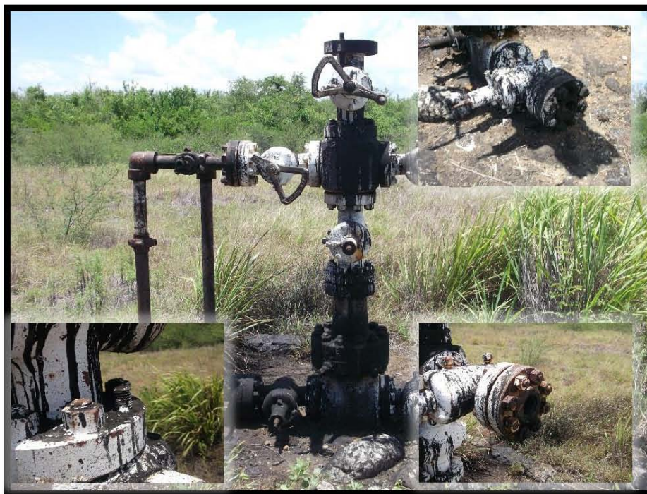
Fotografía 4.- Falta de brida ciega y capuchón en válvula de sondeo, de tapón roscado en válvula lateral derecha y en válvula de tubería de revestimiento lado derecho, falta de volantes, árbol de válvulas con manchas de hidrocarburo.
