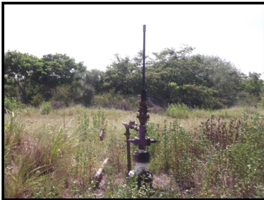
Fotografía 1.- El Pozo Barcodón 107 es un pozo taponado de acuerdo al estado mecánico y el cual fungió como base para reperforar el Pozo Barcodón 107D, en las coordenadas UTM WGS84 X: 606587 Y: 2498005.
