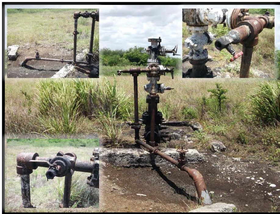
Fotografía 5.- Corrosión y manchas de hidrocarburo en bajante de producción, falta de tapón de 1/2" en válvulas tipo aguja.
