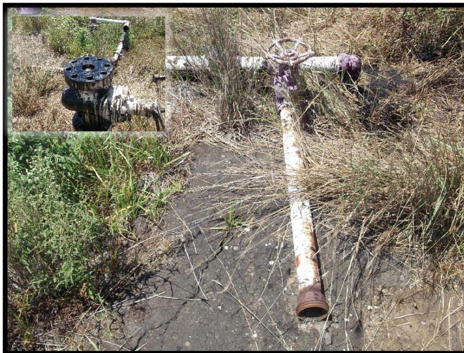
Fotografía 1.- El Pozo Barcodón 101 del Área Contractual Barcodón, fue taponado para volver a ser re-perforado como Pozo Barco 101, Localizado en las coordenadas UTM WGS84 X: 606258 Y: 2498187.
