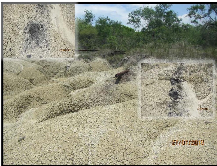
Fotografía 4.- Hidrocarburo intemperizado en escurrimiento temporal sobre Línea de Recolección del Pozo Barcodón 108, en las coordenadas UTM WGS84 X: 606181 Y: 2497268.
