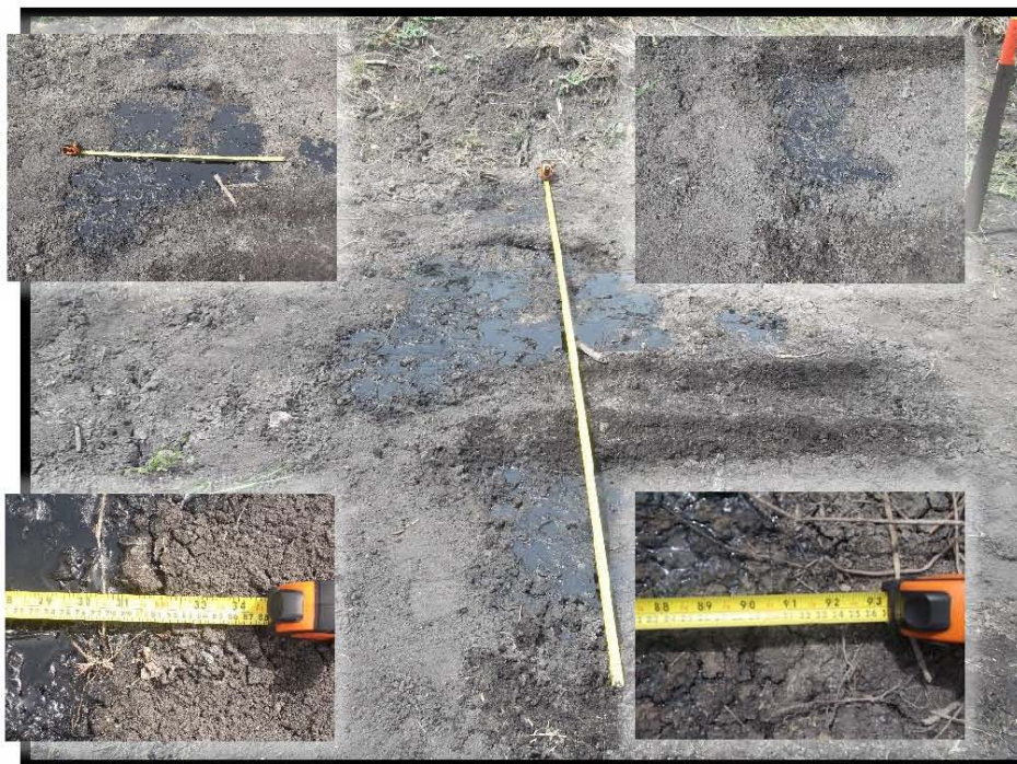
Fotografía 6.- Charco de hidrocarburo 80cm. x 2.35 m. sobre Derecho de Vía del Pozo Barcodón 121, en las coordenadas UTM WGS84 X: 606158 Y:2497496.
