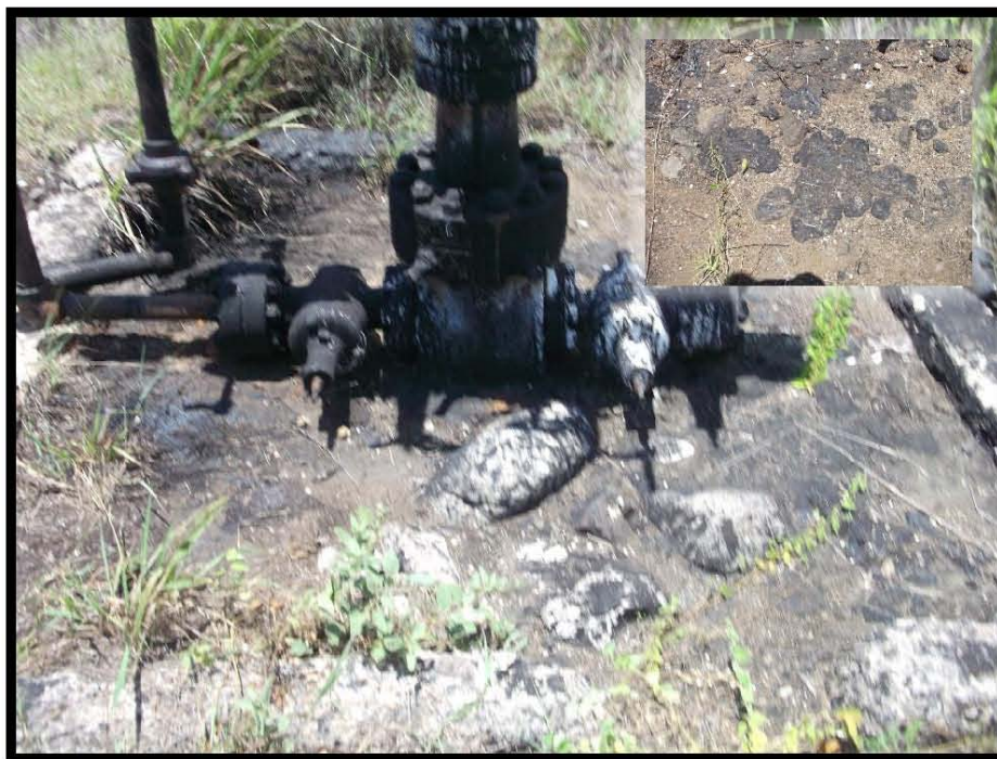
Fotografía 6.- Contrapozo azolvado, hidrocarburo intemperizado en periferia del árbol de válvulas.
