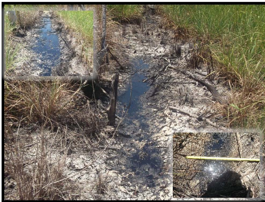
Fotografía 9.- Derrame de Hidrocarburo de 2.2 m de ancho X 9.9 m de largo sobre el Derecho de Vía, en las coordenadas UTM WGS84 X: 606642 Y: 2498130.
