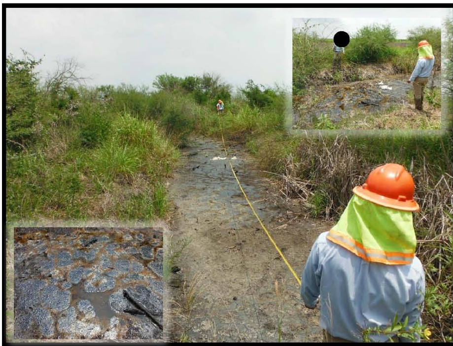
Fotografía 2.- Derrame de hidrocarburo de 23.6 metros de largo por 4 metros de ancho sobre Derecho de Vía, en las coordenadas UTM WGS84 X: 606944 Y: 2496689.
